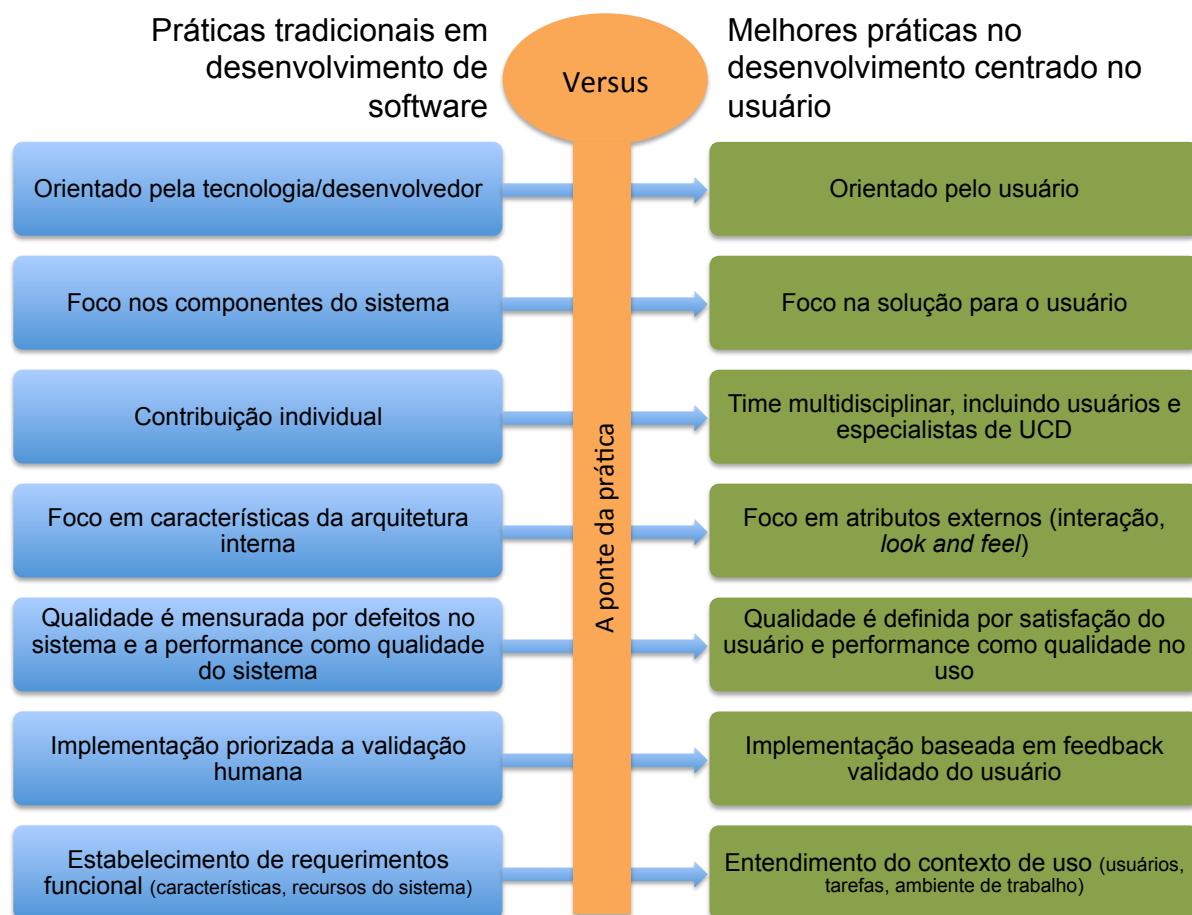
Figura 5- As práticas de desenvolvimento tradicionais de engenharia de software versus as melhores práticas no desenvolvimento centrada no usuário.
